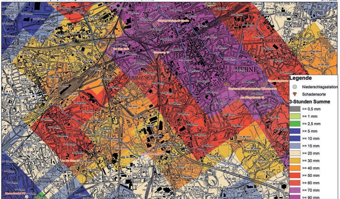
Abb. 14: Maximale 3-Stundensumme [mm] im Stadtgebiet von Herne vom 12. Juli 2014 einschließlich Schadensorte (Zeitraum 19:55 Uhr – 00:50 Uhr, MESZ)
