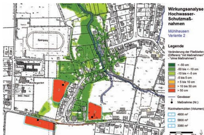
Abb. 5: Wirkungsanalyse möglicher Hochwasserschutzmaßnahmen in Unna-Mühlhausen für ein Starkregenereignis von 90 mm/h
